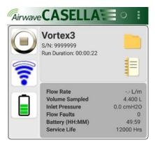
Grazie alla connettività wireless Bluetooth 4.0, con l'app Airwave per Android (scaricabile on line) è possibile collegarsi wi-fi con il proprio smartphone o tablet, per monitorare il campionamento dal proprio dispositivo mobile e trasferire via e-mail i dati, semplificando la creazione di report e l'integrazione con risultati di laboratorio, foto e note.
