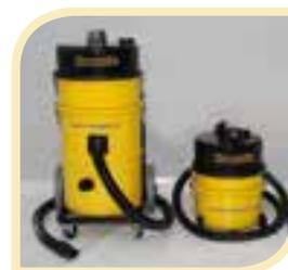
totali con portata di 90 litri al secondo, capacità del serbatoio 35 litri. Il modello HZQ 250 è indicato per trattamenti limitati; è equipaggiato con motore singolo da 1,2 kW - portata 45 litri al secondo. Capacità del serbatoio 10 litri.
