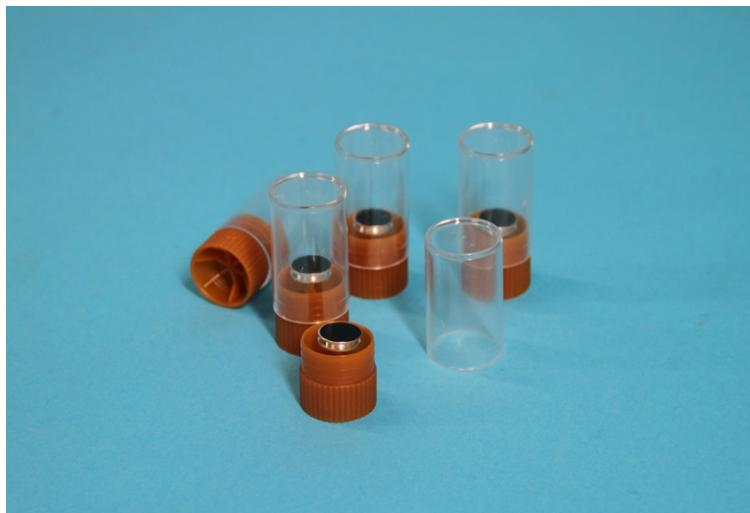
**STUB CONTROLLO POLVERE DEPOSITATA SULLE SUPERFICI**
